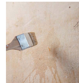
Benetzungsprobe Prüfen der Saugfähigkeit des Untergrundes
