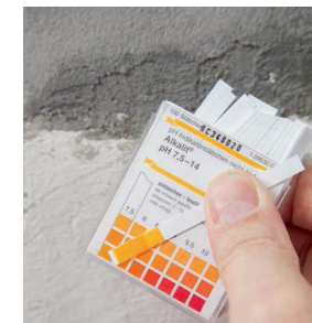
Prüfen des pH-Wertes Hierzu den Untergrund mit destilliertem Wasser benetzen und den pH-Wert mit Indikator- papier bestimmen. Bei ca. 7 liegt ein neutraler Untergrund vor.
